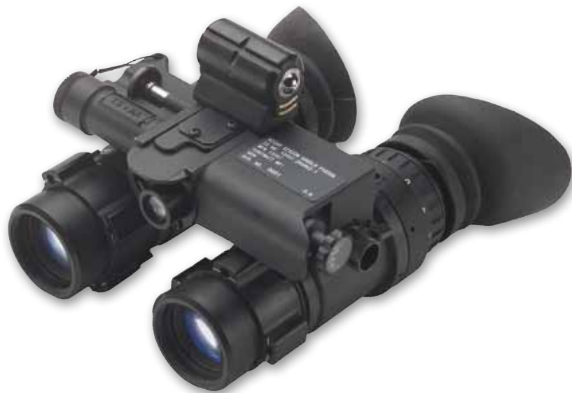
Binokulare. Das AN/AVS-9 ist konzipiert für Piloten, es wird am Helm befestigt und kann herunter- und hochgeklappt werden (links). Das AN/PVS-23 ist für den militärischen Bodeneinsatz gedacht. Es wird ebenfalls am Helm befestigt. Beide Geräte stammen von ITT Nightvision.
