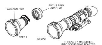
FIGURE 2.19. 3X MAGNIFIER INSTALLATION WITH LIF
