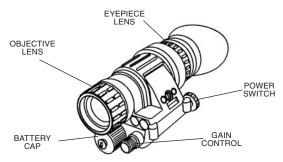
FIGURE 1.4. MULTI-USE NIGHT VISION MONOCULAR
