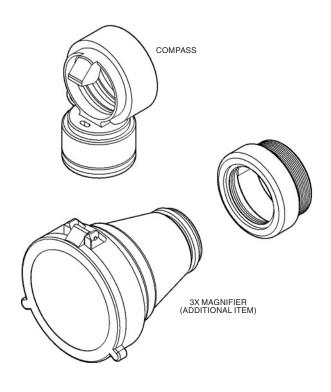
FIGURE 1.2. 3X MAGNIFIER AND COMPASS FOR PVS-14/6015
